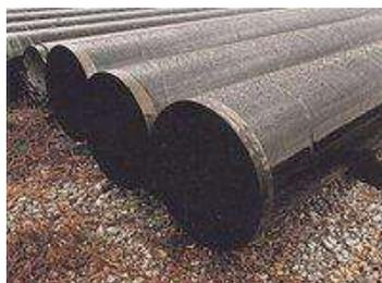
Нанесение полиуретановой смолы осуществляется очень быстро, и труба может почти немедленно быть зарыта в землю. Много трубопроводов во всем мире, были покрыты с использованием этой технологии, чтобы ускорить производство и свести затраты на обслуживание трубопроводов к минимуму.
