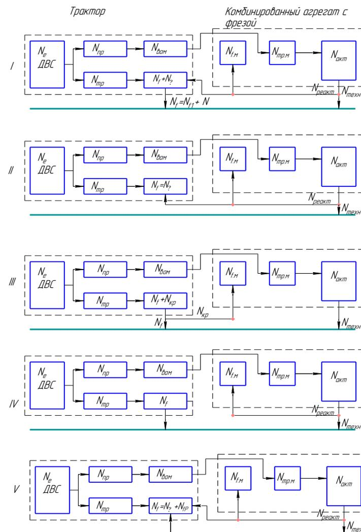
Рис. 2. Схема распределения мощности в комбинированном агрегате с почвенной фрезой
